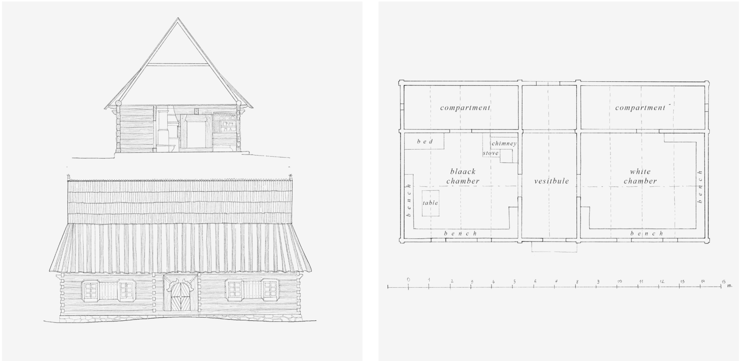
Section, elevation, and plan of a wealthy Highlander home. Drawn by author, dapted from Władysław Matlakowski, Budownictwo Ludowe na Podhalu: Tablice (Kraków: Nakładem Wydziału Wydawniczego Stowarzyszenia Bratniej Pomocy Studentów Wydziałów Politechnicznych A.W., 1948), 15.
